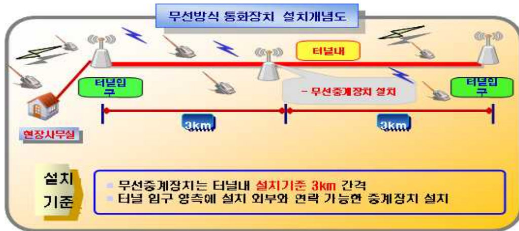
[그림 3-2] 무선방식 통화장치 설치 개념도
