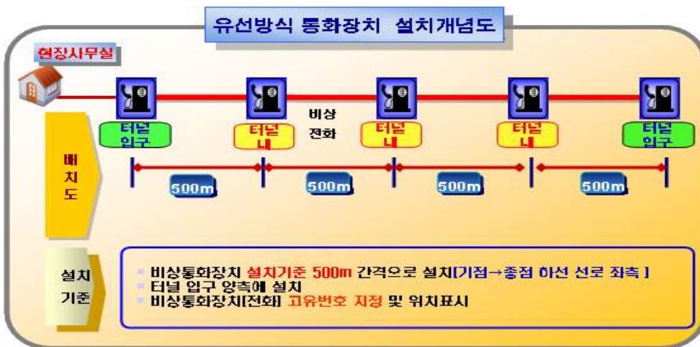
[그림 3-1] 유선방식 통화장치 설치 개념도
